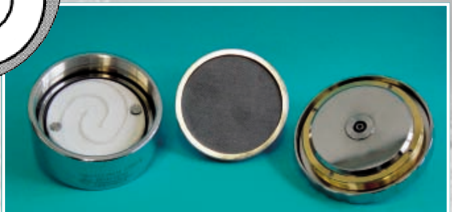
1: Trennzelle mit mäanderförmigem Strömungskanal
